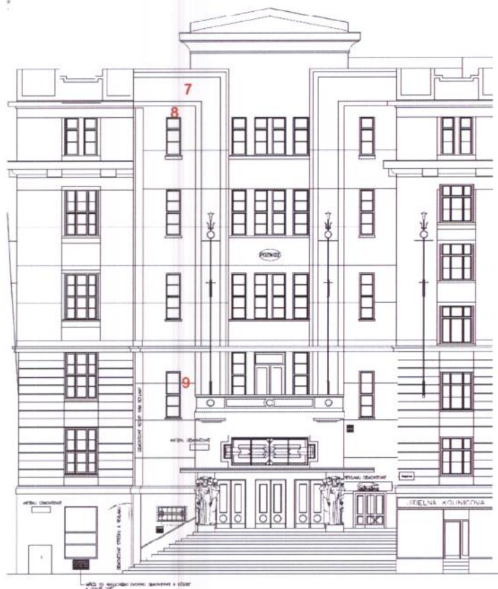
Obr. 2 Místa odběru vzorků omítky – severovýchodní fasáda
